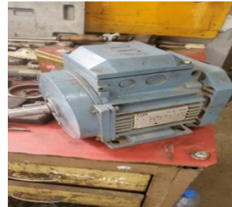
Photo15: ABB motor 1,5KW
